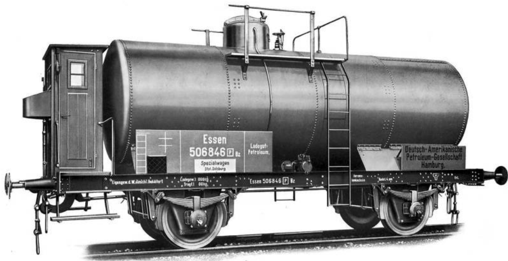
Zweiachsiger Kesselwagen mit Bremse und Bremsenhaus. 19,2 cbm Inhalt — 15 t Ladegewicht. Wagon-citerne à 2 essieux avec frein et guérite. Contenance: 19,2 m 3 — Chargement: 15 t. Tank-wagon with 2 axles, with screw brake and brakeman's cabin. Capacity: 19,2 m 3 — Tonnage: 15 t. Vagón-cisterna de dos ejes con freno de tornillo y garita. Capacidad: 19,2 m 3 — Tonelaje: 15 t.
