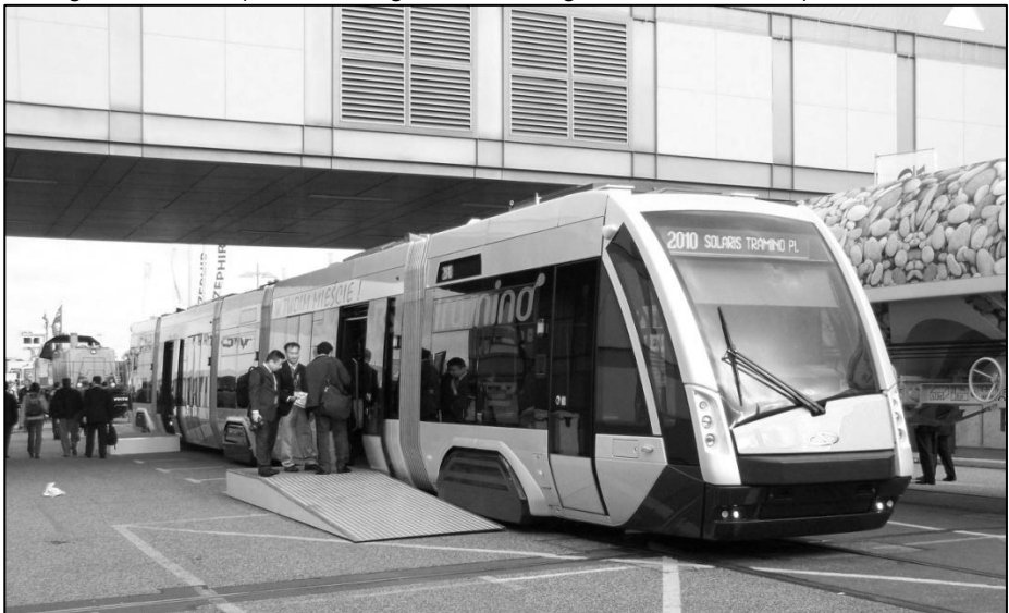
Bild 1: Dieses Fahrzeug ist noch ein Prototyp des Solaris Tramino. In der Serienfertigung für die Stadt Posen wird er aber noch leichter und breiter ausfallen. Foto: Dr. Jürgen Altfeld auf der Innotrans, 21. September 2010.
